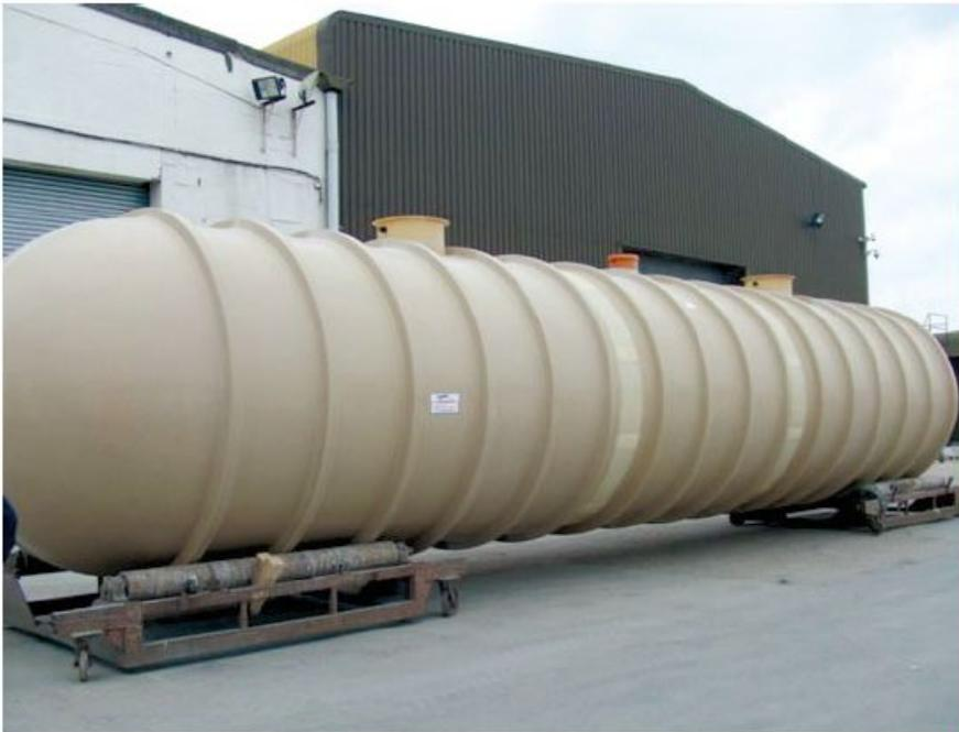
Los ENVIREAU han sido diseñados por KLARGESGTER para ofrecer una solución fácil y fiable al almacenamiento de aguas pluviales para su reutilización, con 1, 2 o 3 bocas de registro según modelo. Pueden equiparse con filtros externos e internos, sistemas de bombeo integrado, sensores de nivel, automatismos, desinfección por ultravioletas, monitorización informática, software de gestión, alarmas, etc.
