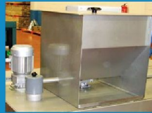
Cuadro eléctrico Dispositivo control entrada y salida Tolva Agitadores hélice marina
